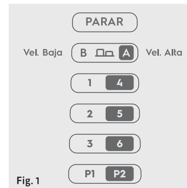
8. Para seleccionar velocidades de 4 a 6 o pulse 2 (P2), se debe presionar el botón **B** hasta la posición "A".
